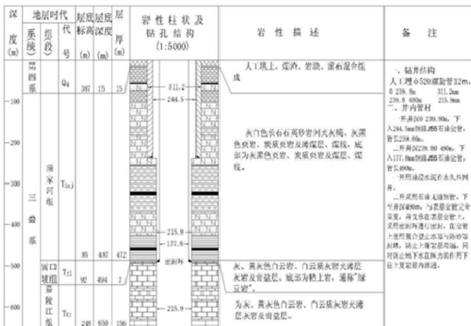
图 8-4 步云山庄地热井水文地质柱状图
